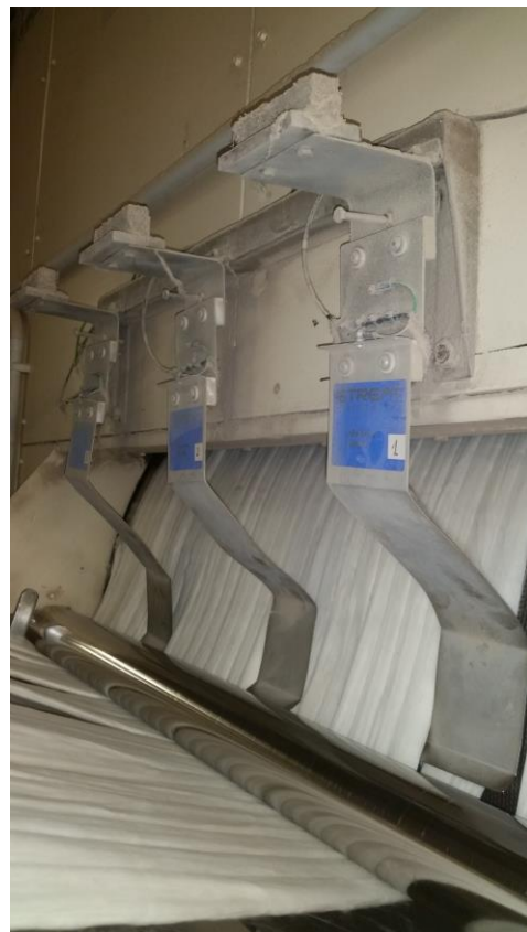
在烘干机出口处，安装在 Superwash 上的 DRYCOM 湿度传感器
